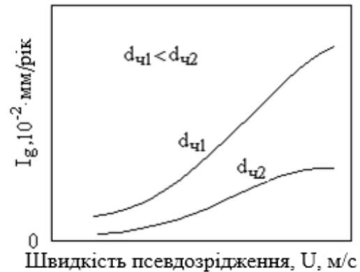
Рис. 4. Характер впливу швидкості псевдозрідження на інтенсивність ЗЕ
